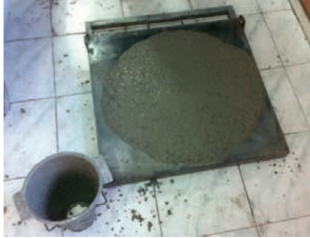
Şekil 1. Yayılma ve T_{50} süresi ölçümü deneyinin yapılışı
