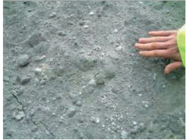
Şekil 2. Düşük Al sahip beyaz cüruf
