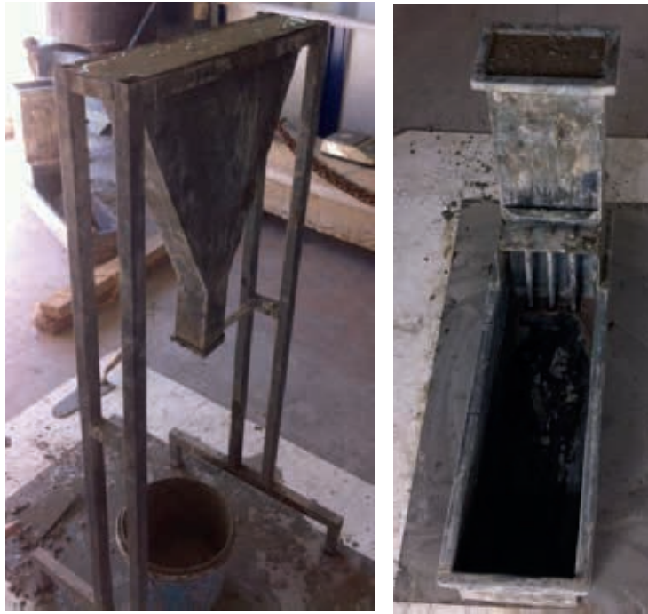
Şekil 2. V hunisi akış süresi ve L kutusu deneyinin yapılışı
