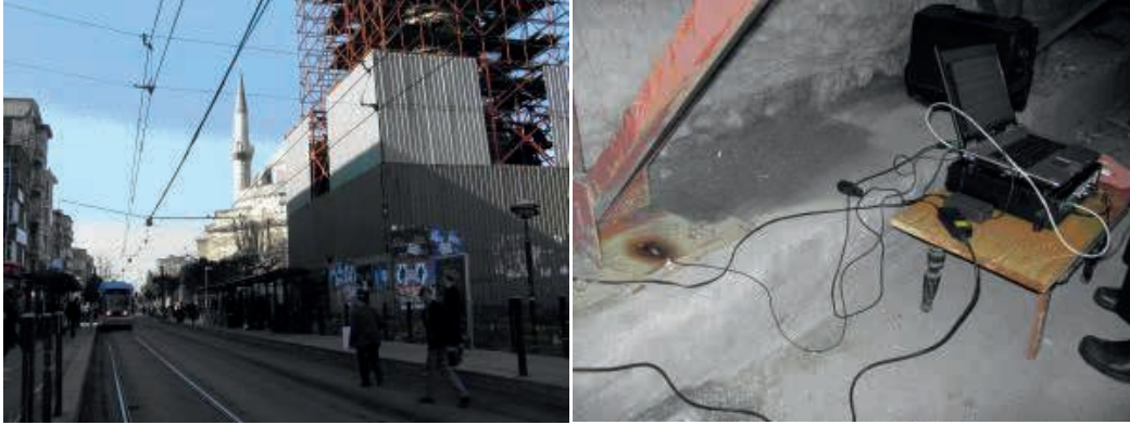
Resim-2 İstanbul Çemberlitaş sütunu temelinde zemin titreşim ölçümü
