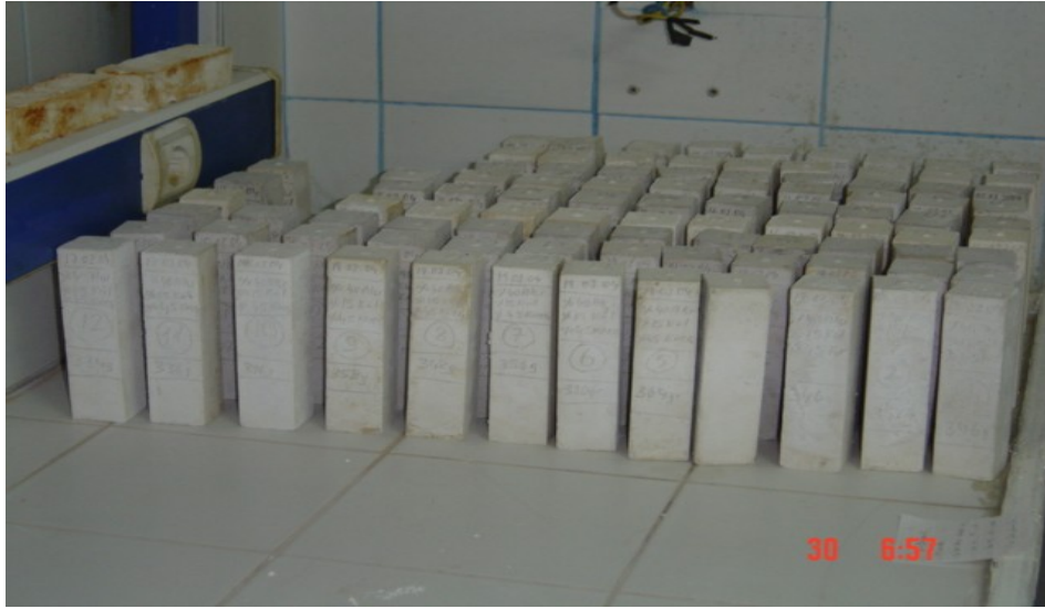
Şekil 1. Kalıptan Çıkarılmış Tuğla Numuneleri
